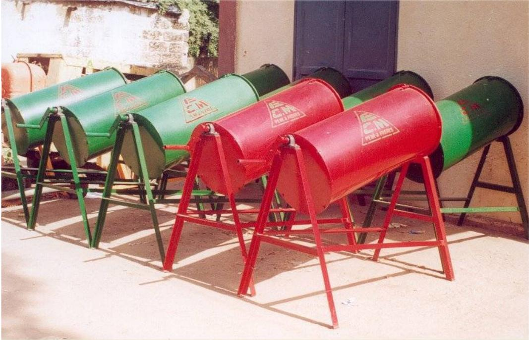
*En haut : Mélangeurs de grain fabriqués par le RESOPP. Les rouges sont destinés au traitement des semences, les verts au grain de consommation.*
